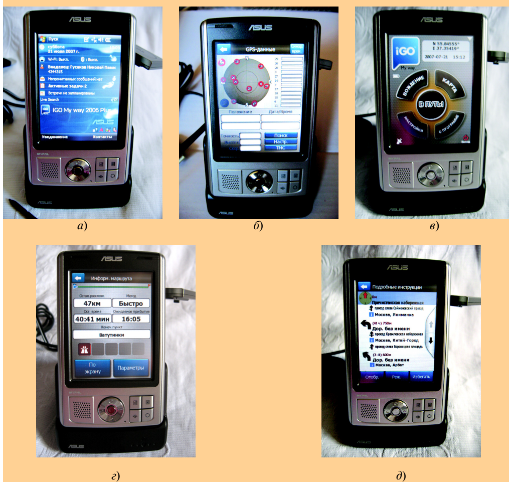
Рис. 15: а) GPS-навигатор; б) GPS-навигатор «ищет» спутники; в) стартовая страница программы I-go; г) информация о маршруте; д) подробное описание маршрута;
